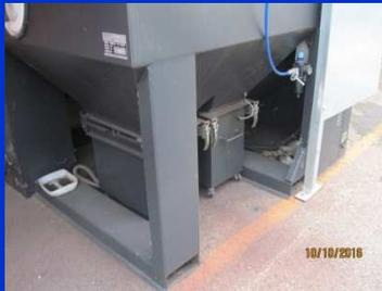
**Manutenzione: svuotamento sacco di raccolta delle polveri fini che si formano per condensazione dei fumi ( filtri a manica)**
