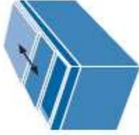
Figure 5. Couvercle télescopique
